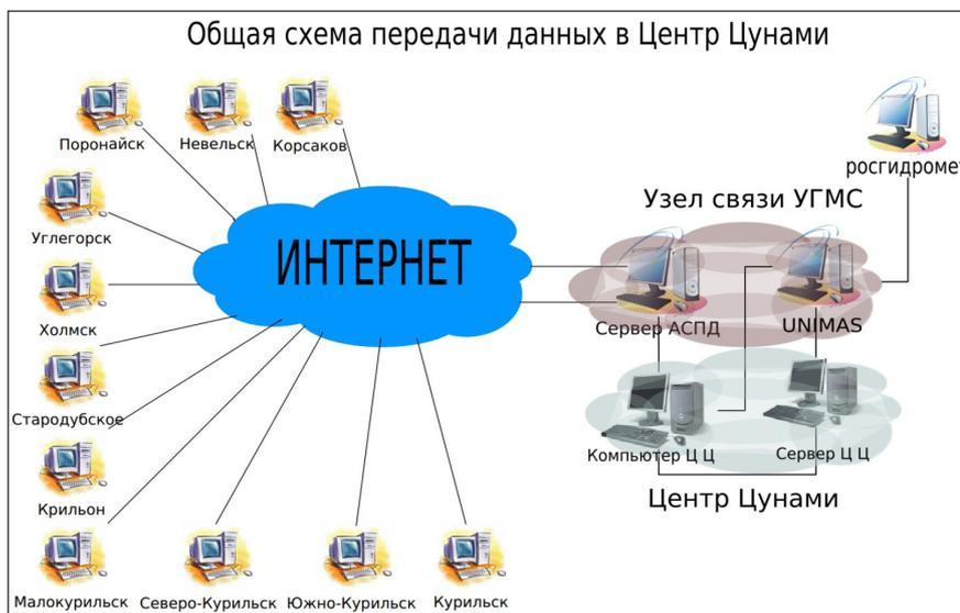
Рис. 15.8. Схема передачи данных о колебаниях уровня океана на компьютер дежурного оператора в Южно-Сахалинске.
