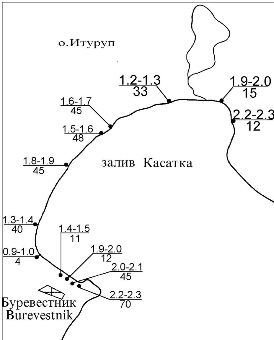
Рис. 11.3. Высоты и дальности затопления побережья залива Касатка, о. Итуруп.
