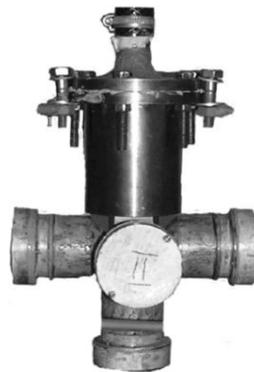
Рисунок 2.4 – Система направленных гидрофонов
