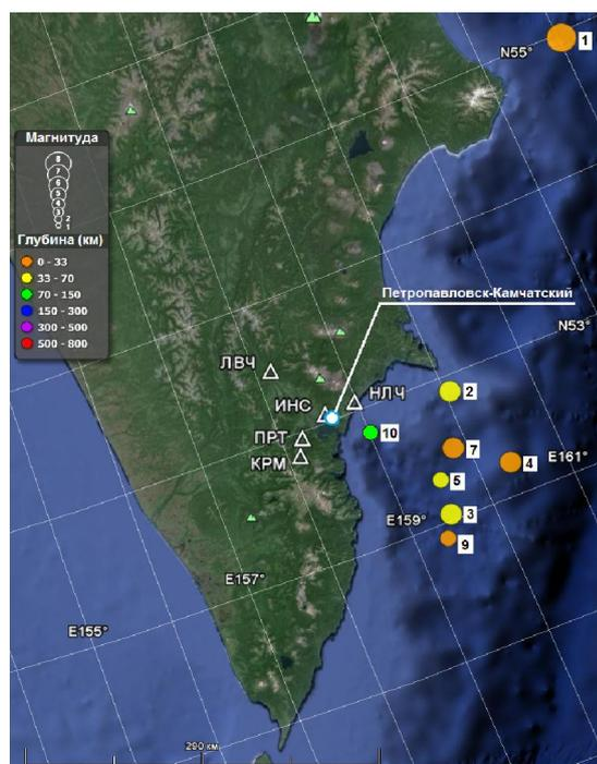
Рисунок 4.1 – Сеть пунктов мониторинга концентрации подпочвенного радона и карта эпицентров землетрясений, имеющих радоновый предвестник (номера согласно таблице 4.1).
