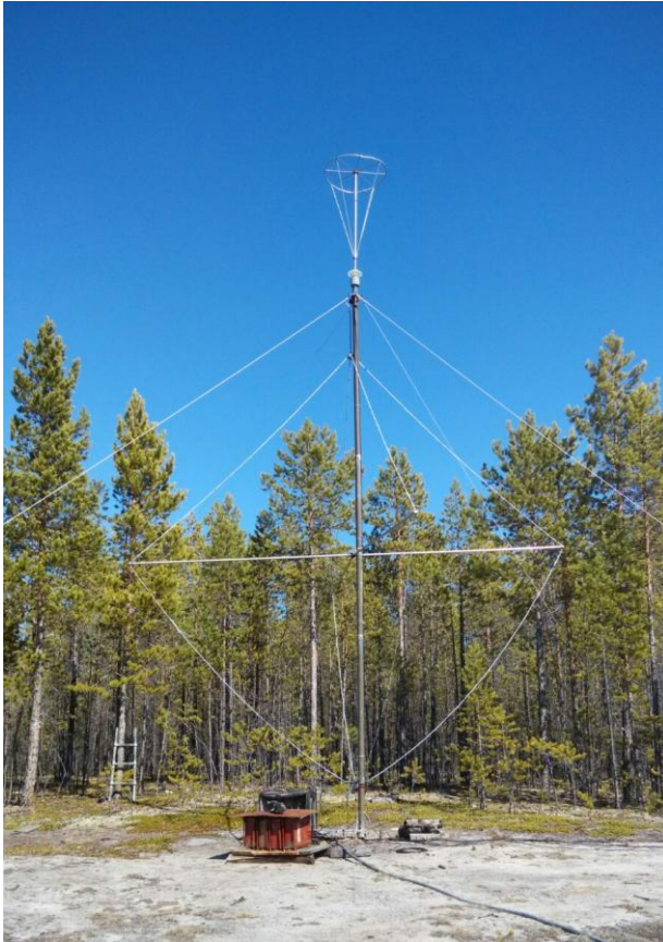
Рисунок 2.2 – Однопунктовый грозопеленгатор-дальномер на радиофизическом полигоне ИКФИА СО РАН
