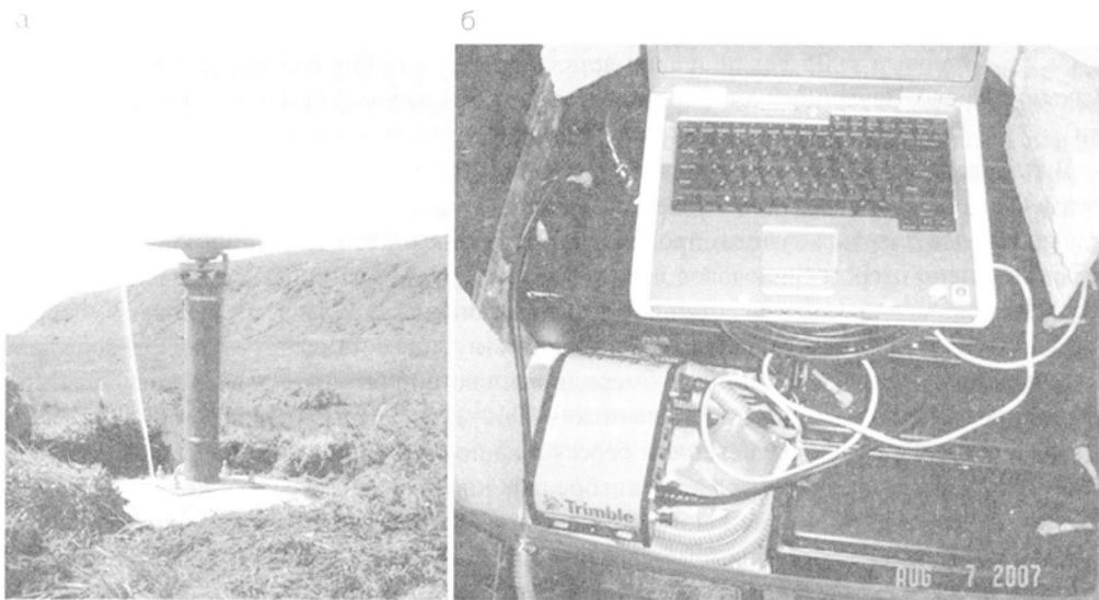
Автономная GPS-станция непрерывной регистрации (о-в Матуя): а) пylon с антенной; б) контейнер с GPS-приемником и батарейным питанием
