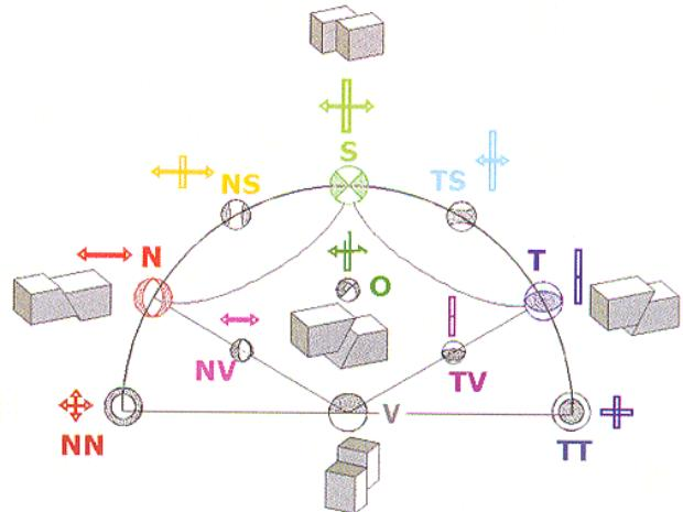
Рис. 1. Классификации режимов сейсмоконтакционной деформации
