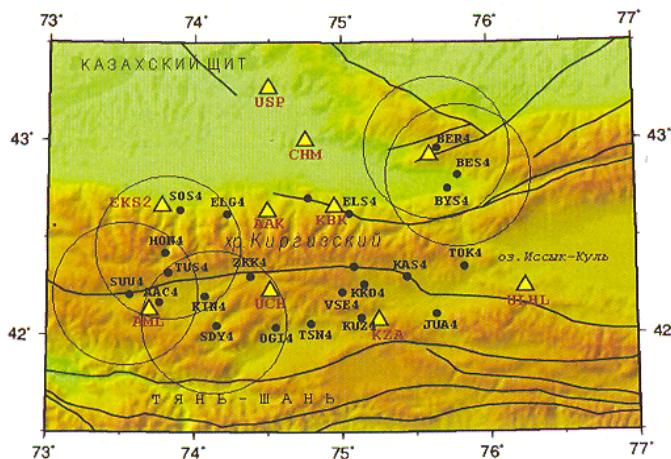
Рис. 4. Пример набора узловых точек (пункты GPS) для расчета СТД. Окружности – области расчета
