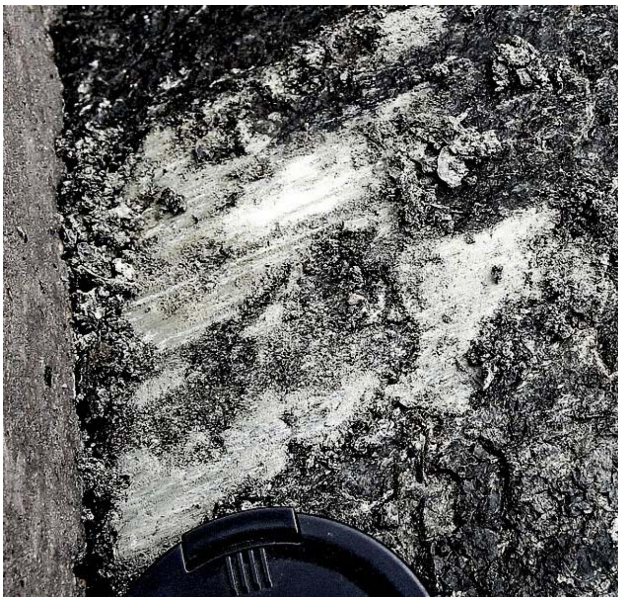
Рис. 2. Одно из крупных зеркал скольжения, возникшее на плоскости разлома во время прерывистого перемещения плиты. При формировании зеркала сейсмодатчики регистрировали пакеты сейсмических импульсов с высокими значениями амплитуд сейсмических ускорений.
