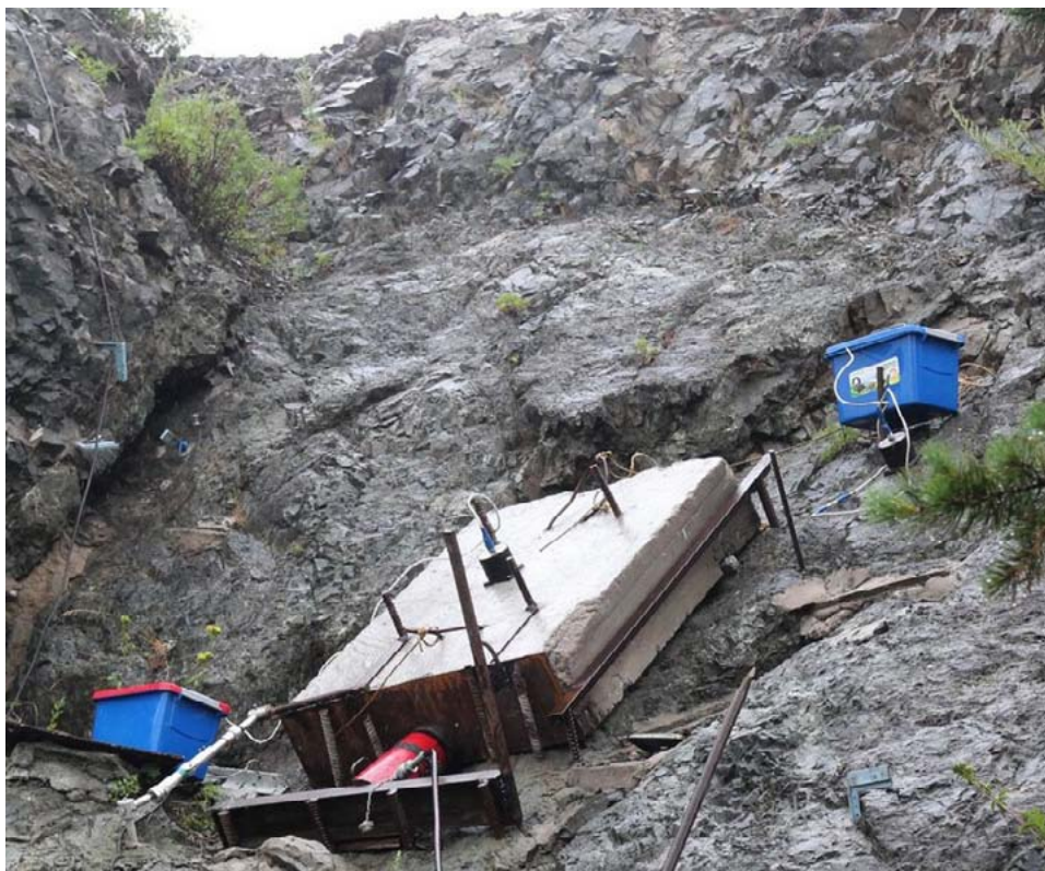
Рис. 1. Расположение плиты на плоскости Ангарского разлома. Видно сейсмостанции, домкрат, датчики линейного смещения и силы.
