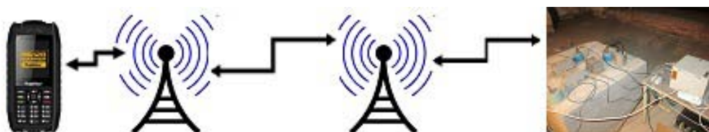
Рис. 2. Типовые промышленные элементы функциональной схемы удалённого доступа к сейсмической станции.
