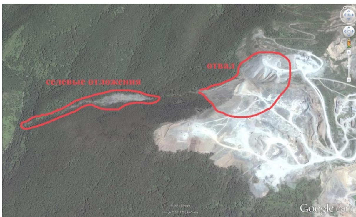
Рис. 4. Селевой бассейн с зонами зарождения, транзита и аккумуляции. Снимок Google от 29.08.2014 г.
