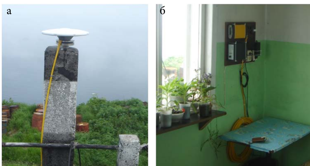
Рис. 2. Общий вид геодезического центра и GPS/ГЛОНАСС антенны (а) и размещения спутникового приемника на пункте «Монерон» (MONR), о. Монерон (б).
