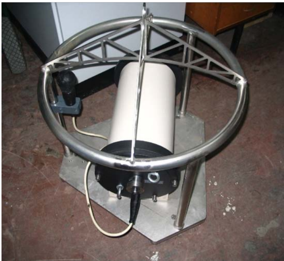
Рис. 2. Донный сейсмограф СГДМ.
